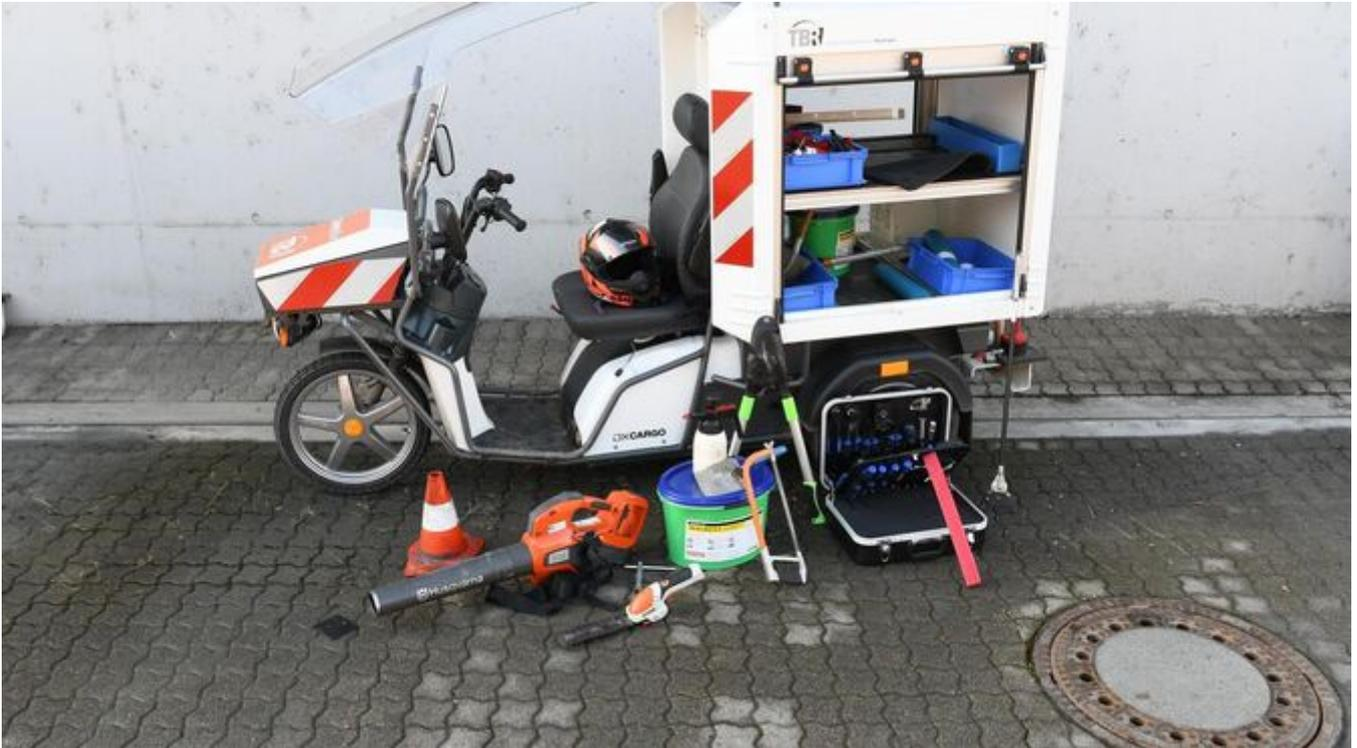
An Bord des Safety Bike ist ein Sortiment von Werkzeugen von der Schaufel bis zum Laubbläser. Sogar ein Eimer Kalt-Asphalt-Mischgut zum Flicker kleiner Wegschäden. Foto: Stephan Zenke
